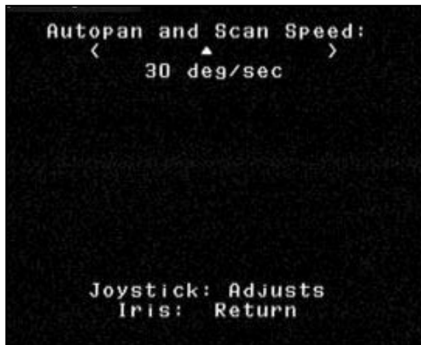
Figura 6. Regolazione della velocità di panoramica/scansione in automatico
