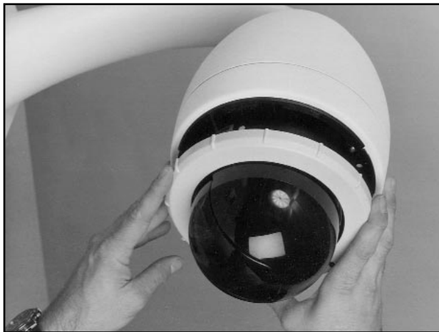
Foto 7: Kamera Modul einsetzen
