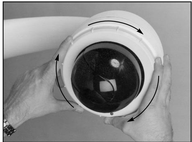
Foto 8: Kamera Modul in Position drehen
