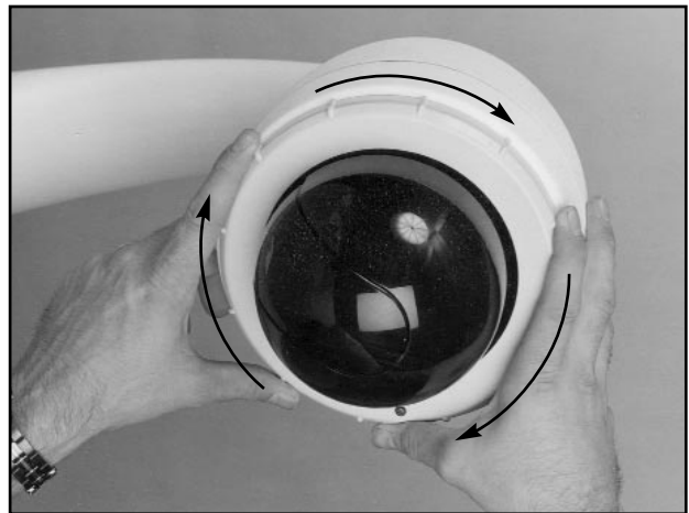
Foto 8: Draai camera module op zijn plaats
