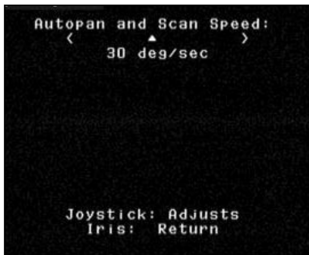
Figure 6. Réglage vitesse auto/pan et balayage auto
