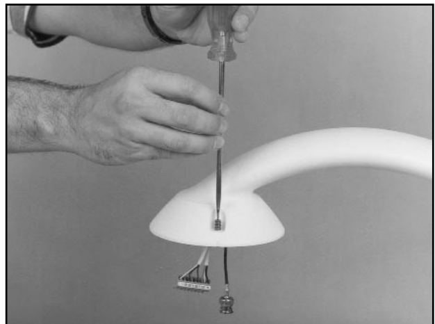
Photo 2: Retirer les vis existantes
