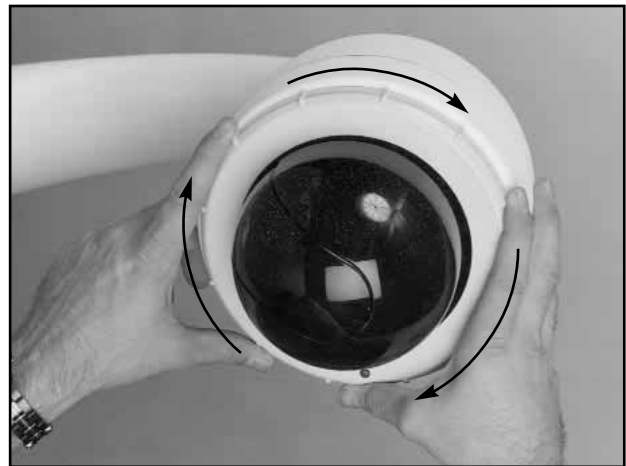
Foto 8: Drej Kamera Modulet på plads
