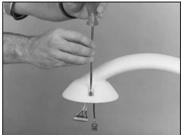
Foto 2: Fjern eksisterende skruer
