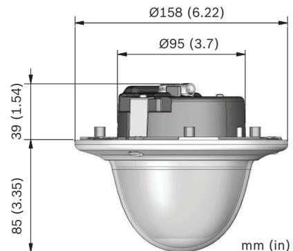
**Размеры для монтажа на поверхность**
