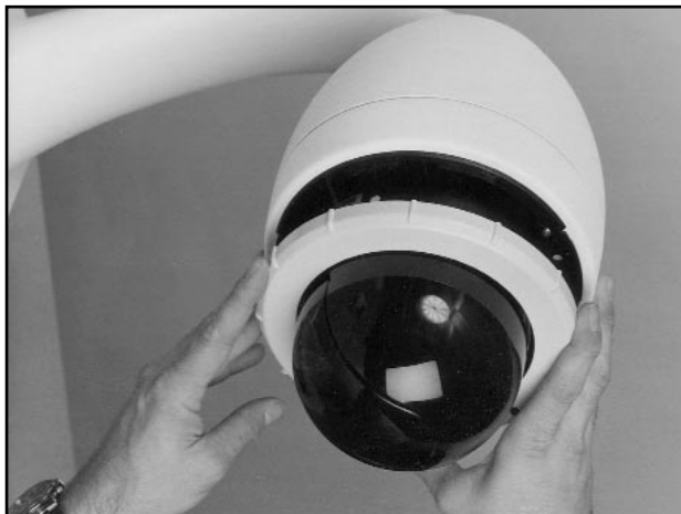
Foto 7: Plaats camera module
