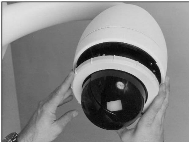
Foto 7 : Instale el módulo de cámara
