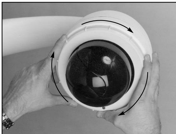
Foto 8 : Gire el módulo de cámara a su posición
