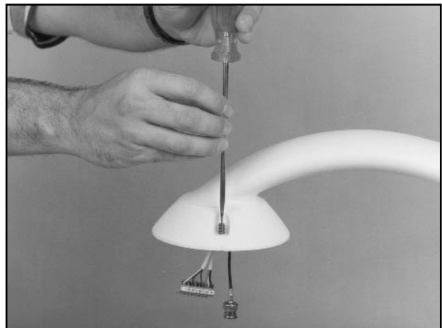
Foto 2 : Quite los tornillos existentes
