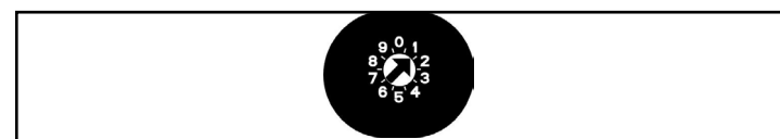
Figure 2.1 : Commutateur d'adresse réglé sur l'adresse 1
